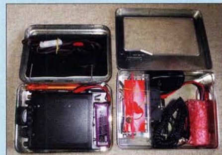
Beispiel für eine zum Transport vorbereitete Portabel-Funkstation mit Yaesu FT-817 nebst kleinem Akkumulator und Zusätzen; nicht dargestellt ist die Antenne.
