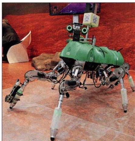
Der Aufbau des sechsbeinigen Laufroboters Lauron V des Forschungszentrums Informatik ist einer Stabheuschrecke nachempfunden.
