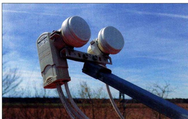
Bild 1: Dual-Feed-Halter für den Empfang von zwei Satelliten; rechts ist der LNB für den Es'hail-2 angebracht, links der für den Astra-Satelliten.
