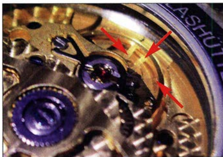
Bild 16: Wie Bild 15, jedoch mit t_{\text{Bel}} = 1/25\text{ s} aufgenommen und dadurch dreifacher Abbildung eines Unruhschenkels
