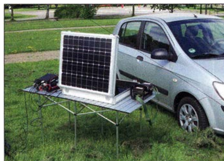
... mit Solarpanel als mobile Stromversorgung
