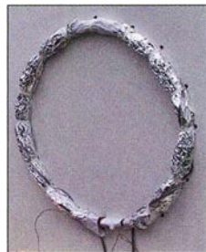
Eigenbau-Loopantenne von Carsten, DG0JCG, für den Einsatz auf 17,2 kHz
