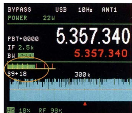
S9 + 18 dB Störpegel auf dem Display eines Ten-Tec Omni VII an einer Inverted-V für 60 m
