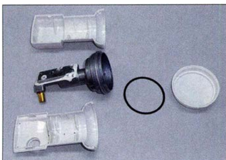
Bild 8: Ein LNB, wie hier der Goobay 67269, ist nicht schwer zu zerlegen und anschließend wieder zusammenzubauen.
